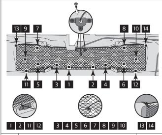
Э Т А П 3. Установите ранее демонтированные штатные винты. Зафиксируйте изделие специальными крепежными хомутами, входящими в комплект поставки.
