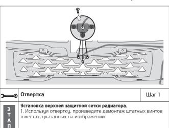
ВАЖНО! Перед началом установки защитной сетки радиатора произведите демонтаж бампера и гасителя удара (см. руководство по эксплуатации автомобиля).
