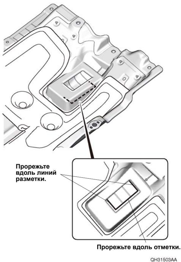
8. Отметьте левую подкузовную панель.
