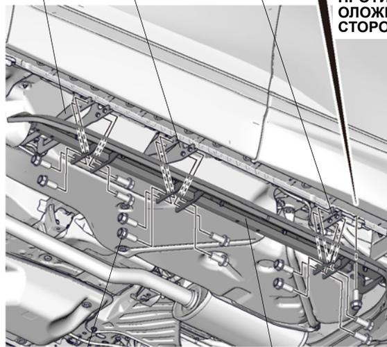
13 ФЛАНЦЕВЫХ БОЛТА (Установите без фиксации.)
