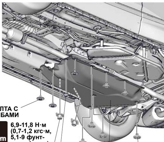
3. Снимите правую подкузовную панель.
