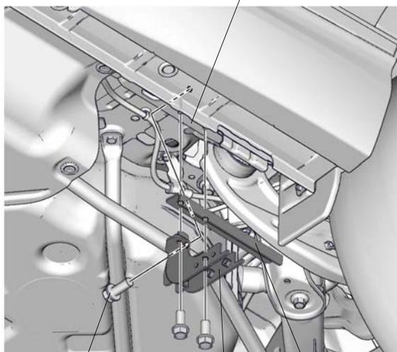
3 ФЛАНЦЕВЫХ БОЛТА (Установите без фиксации.)
