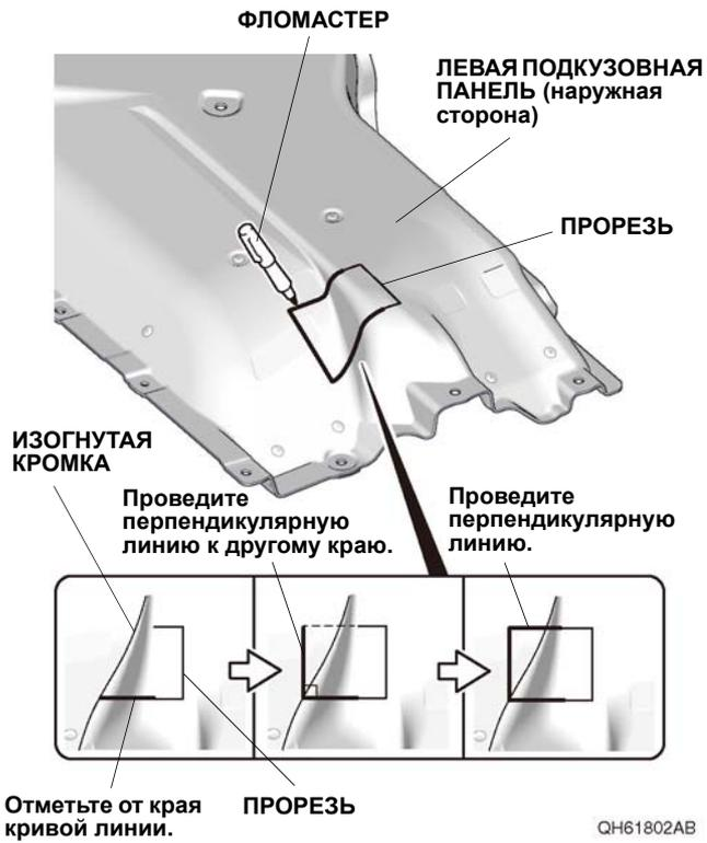
9. Прорежьте левую подкузовную панель.
