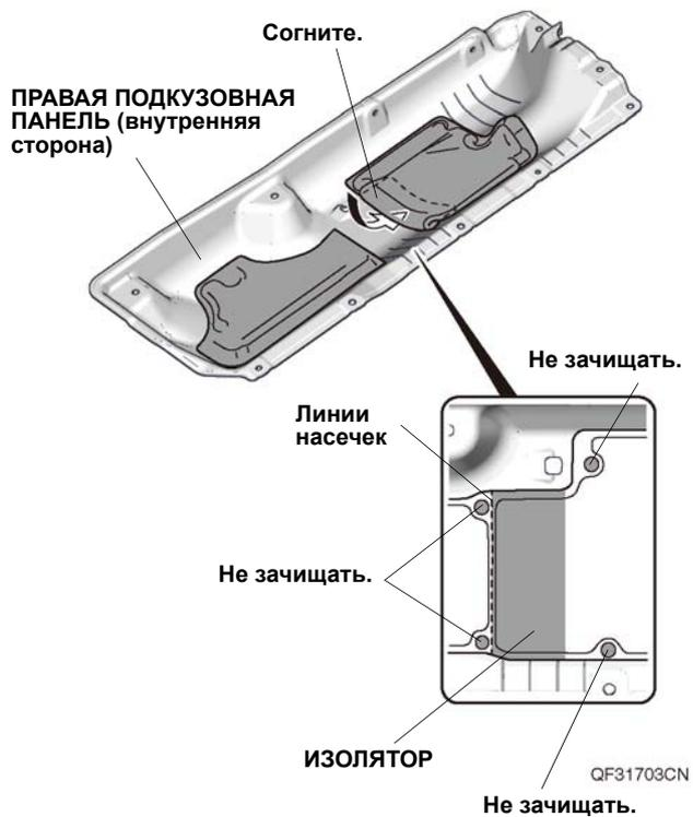
13. Прорежьте правую подкузовную панель.
