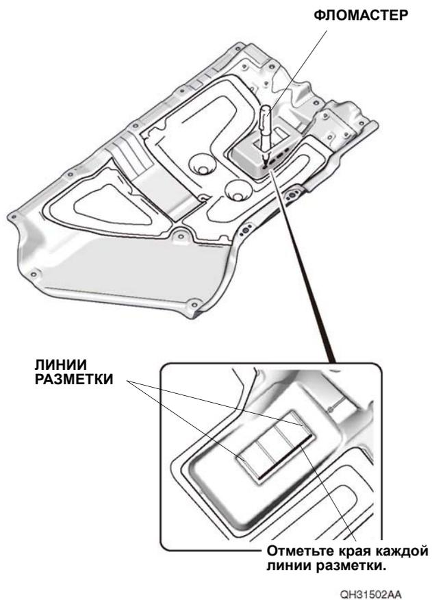
7. Прорежьте левую подкузовную панель.
