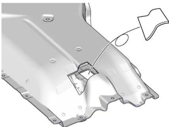
10. Прорежьте левую подкузовную панель.
