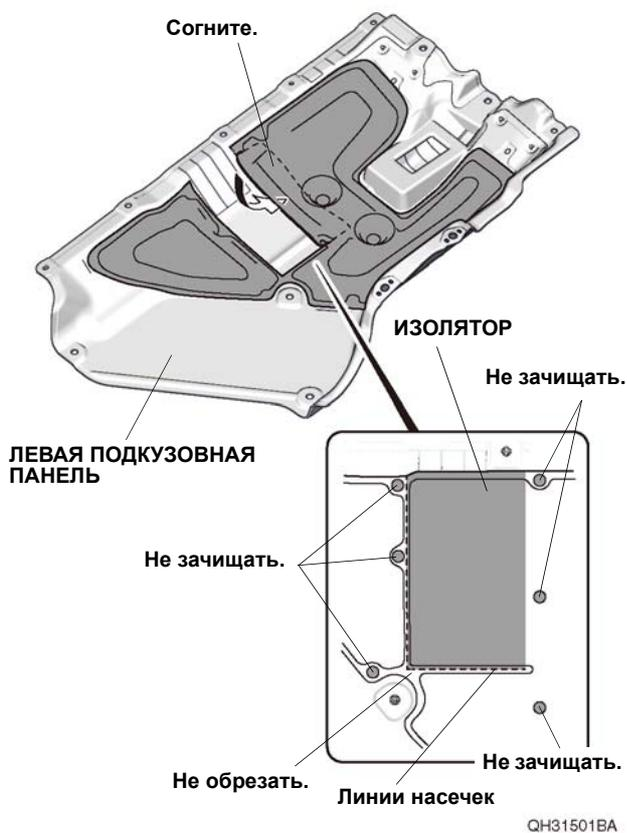
6. Отметьте левую подкузовную панель.
