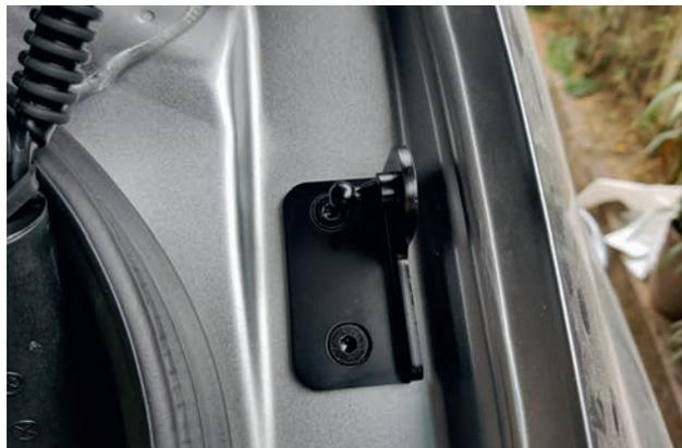
5. В резьбовые отверстия оригинальных шарниров на двери установите шарнирные штифты и шайбы, входящие в комплект поставки, затяните моментом 12 Н·м.
