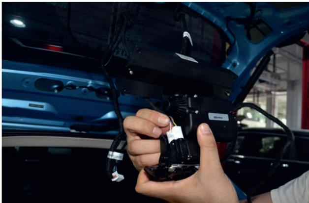
4. Установите новый замок, с помощью торцевого ключа на 10 затяните болты.
