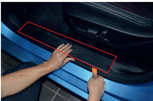
2. Снимите показанную на рисунке треугольную декоративную панель в ногах водителя.
