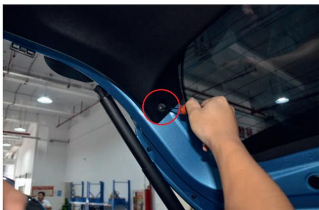
2. При помощи крестовой отвертки открутите винт задней двери, как показано на рисунке.
