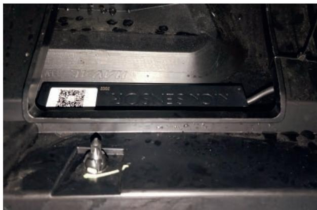
3. Проложите жгут проводов датчика движения ноги в салон через резиновый уплотнитель жгута проводов бампера в левой части багажного отделения.
