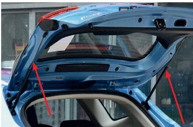
2. С помощью торцевого ключа на 10 снимите кронштейны оригинальных упоров.
