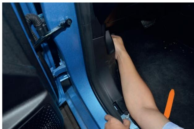
3. При помощи пластиковой монтажной лопатки снимите левую треугольную декоративную панель со стороны водителя.
