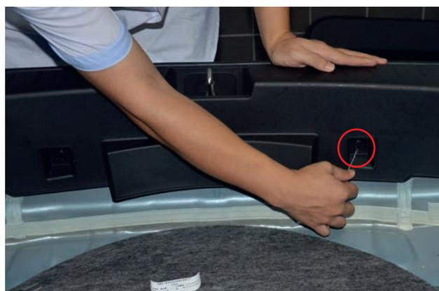
5. Снимите декоративную панель багажного отделения.
