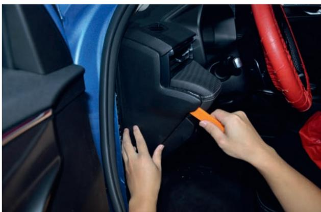
4. Снимите декоративную панель блока предохранителей.
