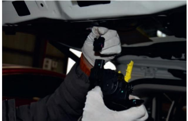
3. Подключите к новому замку с прижимным устройством разъем жгута проводов С.
