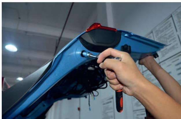
6. Установите новые электроприводы, проверьте маркировку и отделите левый привод от правого: на левом нанесена отметка **L**, на правом — **R**; Электропривод должен быть ориентирован жгутом проводов к кузову автомобиля и установлен на кронштейн. Сторона привода без жгута проводов устанавливается на шарнирный штифт на двери багажника (как показано на рисунке).
