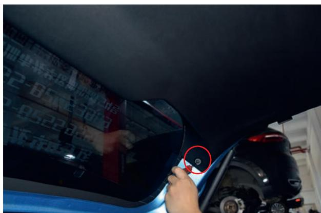
3. При помощи пластмассовой монтажной лопатки подденьте декоративную панель задней двери.
