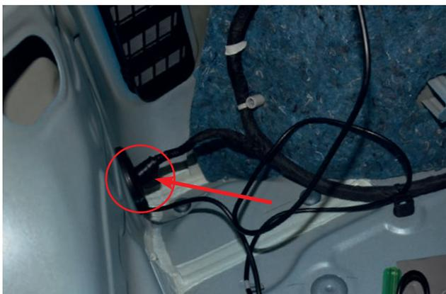
4. Подсоедините разъем датчика движения ноги к разъему на жгуте проводов В.
