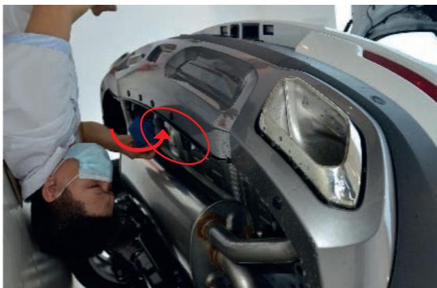
2. Расположите датчик движения ноги надписью и QR-кодом к земле и зафиксируйте его на панели кузова.
